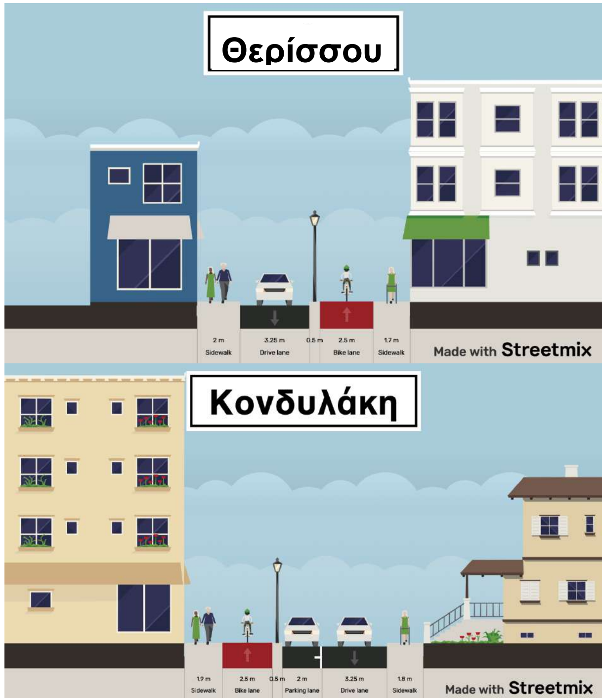
Εικόνα 84: Παραδείγματα ενδεικτικών μελλοντικών διατομών για τις οδούς Θερίσου και Κονδυλάκη
