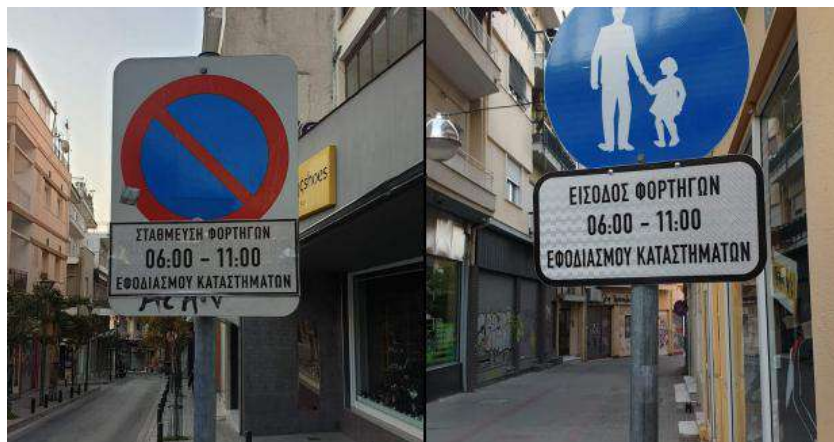
Εικόνα 91: Παράδειγμα εφαρμογής κατακόρυφης σήμανσης για τη ρύθμιση του ωραρίου τροφοδοσίας
