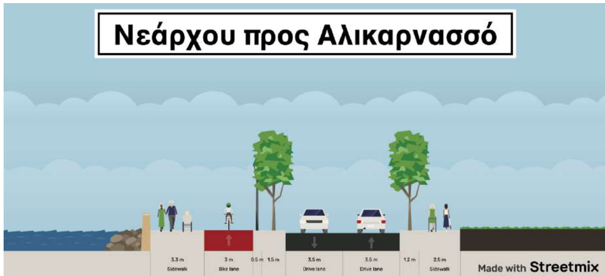
Εικόνα 73: Ενδεικτική προτεινόμενη Διατομή οδού Νεάρχου προς Αλικαρνασσό (πλάτους 19μ.) με ποδηλατόδρομο
