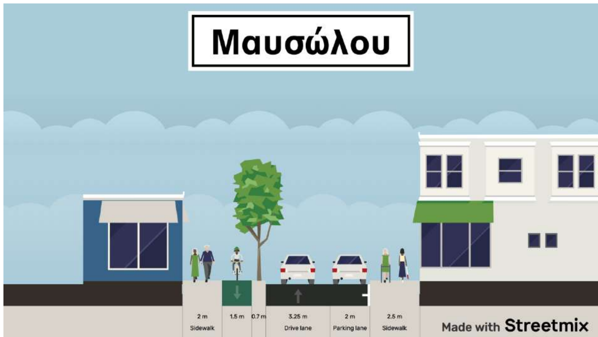
Εικόνα 79: Ενδεικτική προτεινόμενη Διατομή οδού Μαουσώλου (πλάτους 11,95μ.) με ποδηλατόδρομο
