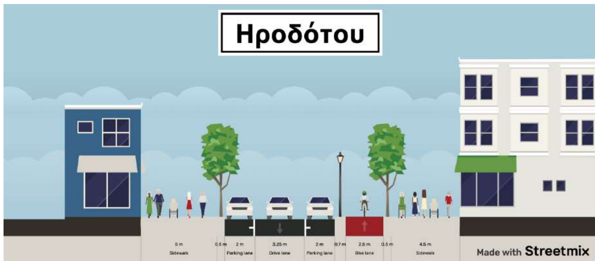
Εικόνα 74: Ενδεικτική προτεινόμενη Διατομή οδού Ηροδότου (πλάτους 20,95μ.) με ποδηλατόδρομο
