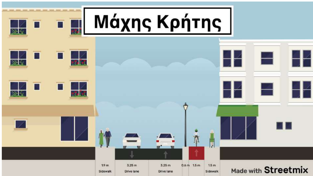
Εικόνα 65: Ενδεικτική προτεινόμενη Διατομή οδού Μάχης Κρήτης (πλάτους 12μ.) με ποδηλατόδρομο
