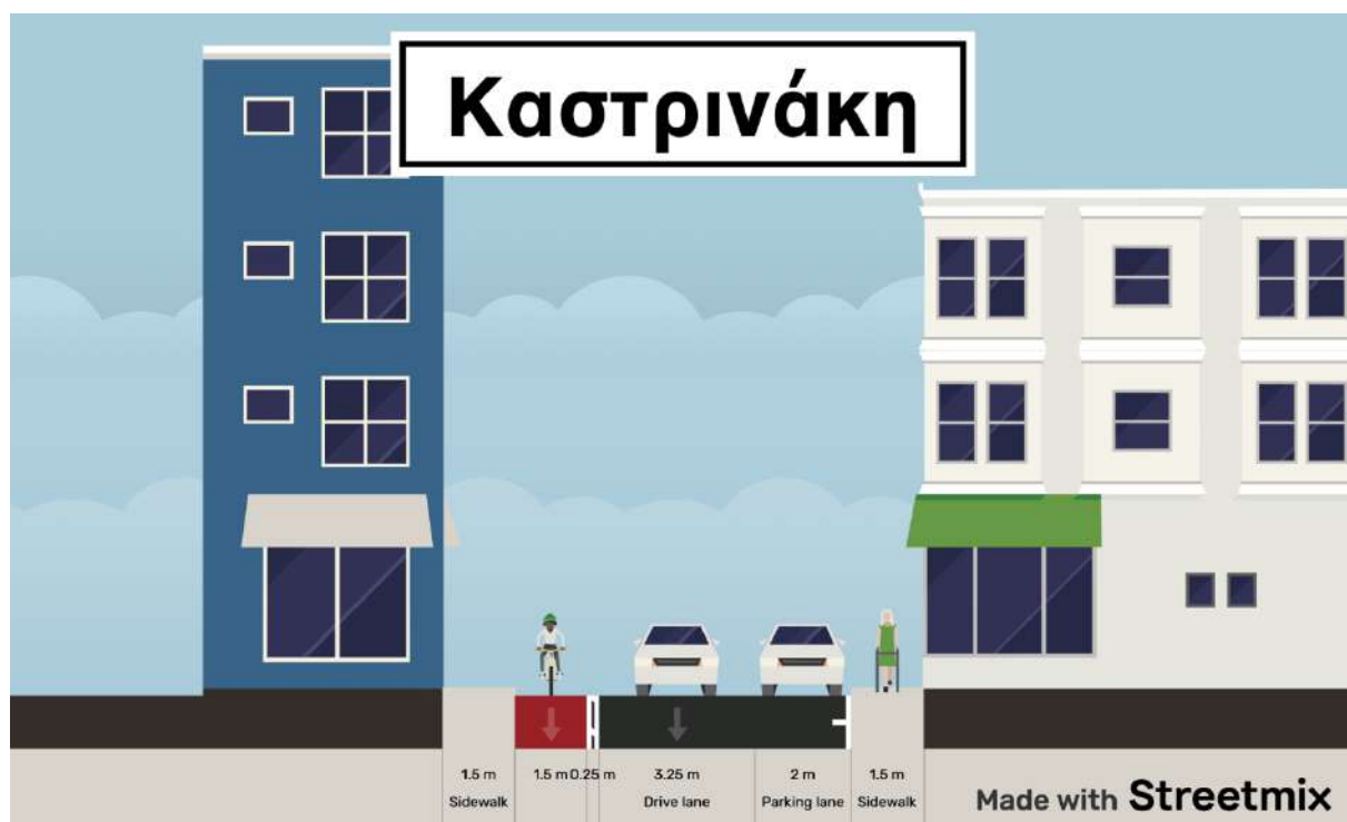
Εικόνα 68: Ενδεικτική προτεινόμενη Διατομή οδού Καστρινάκη (πλάτους 10μ.) με ποδηλατόδρομο
