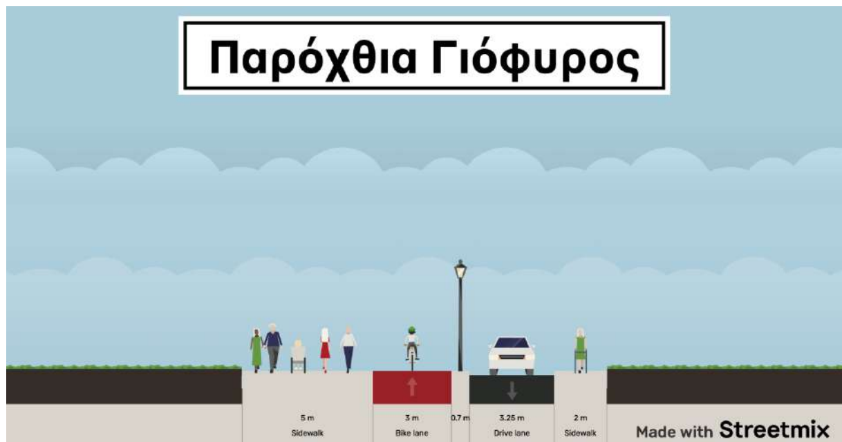
Εικόνα 72: Ενδεικτική προτεινόμενη Διατομή παρόχθιας διαδρομής Γιόφυρου (πλάτους 13,9μ.) με ποδηλατόδρομο
