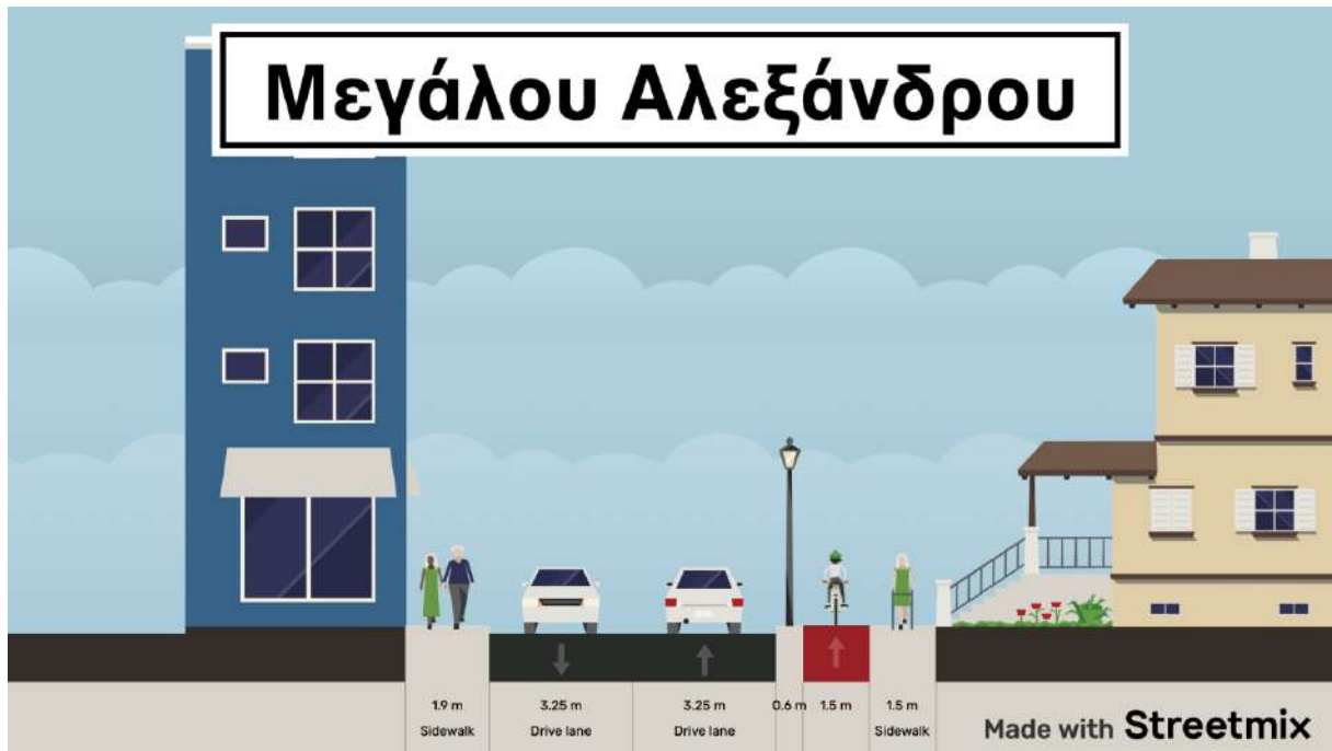
Εικόνα 69: Ενδεικτική προτεινόμενη Διατομή οδού Μεγάλου Αλεξάνδρου (πλάτους 12μ.) με ποδηλατόδρομο
