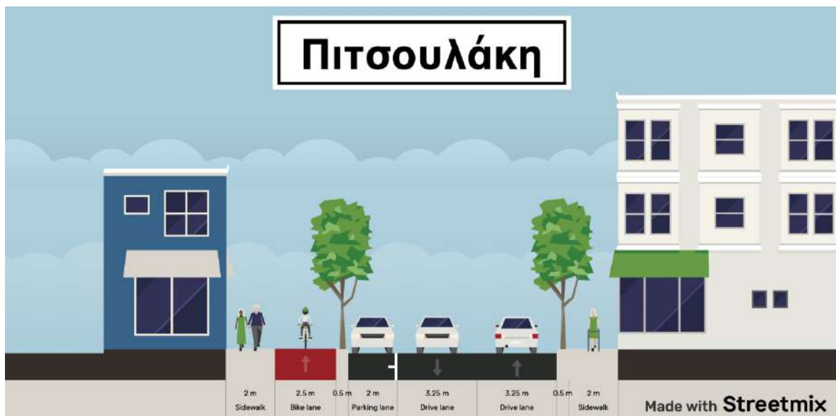
Εικόνα 75: Ενδεικτική προτεινόμενη Διατομή οδού Πιτσουλάκη (πλάτους 16μ.) με ποδηλατόδρομο
