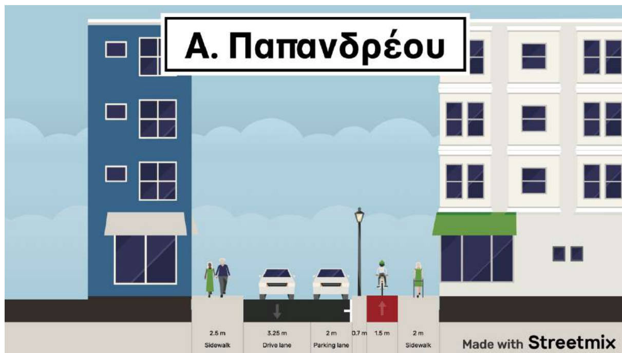
Εικόνα 67: Ενδεικτική προτεινόμενη Διατομή οδού Α. Παπανδρέου (πλάτους 12μ.) με ποδηλατόδρομο
