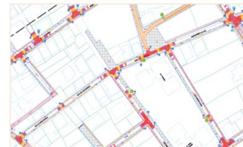
Εικόνα 2. Η νέα εικόνα της οδού Βορεάδη στην καρδιά της Σχολειούπολης με νέες επιστρώσεις και παρεμβάσεις για την σαφή οριοθέτηση της κίνησης πεζών και οχημάτων, υπερυψωμένα τμήματα, ασφαλείς διασταυρώσεις
